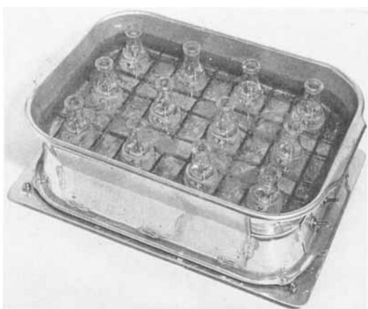
Fig. 3—Magnetic stirrer-ice bath apparatus.
